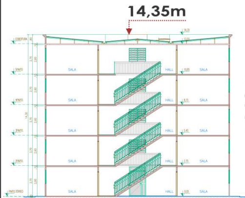
CORTE TRANSVERSAL (BLOCOS 2 AO 17)
