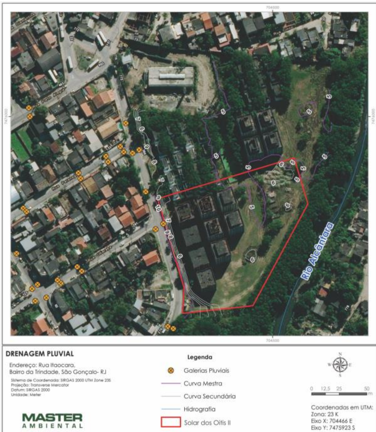
Curvas de Nível e Dispositivos de Drenagem.
