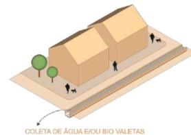
Nas vias onde não há corredor verde, podem ser instaladas biovaletas ou calhas para escoamento da água da chuva.
